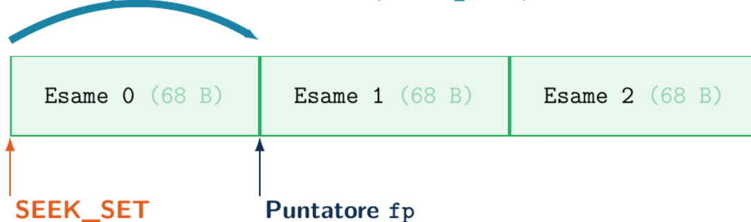
Figura 13.2: I/O Diretto con Array di Struct su File Binario
